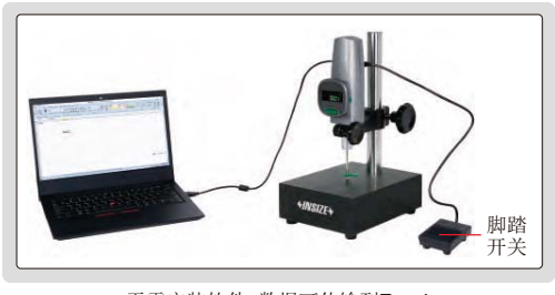
无需安装软件, 数据可传输到Excel; 短按脚踏开关采集数据, 长按置零
